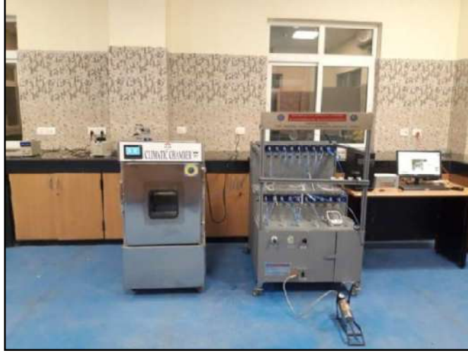
OIML R-16 के अनुसार परीक्षण के दौरान अंतिम संयोजन प्रणाली
