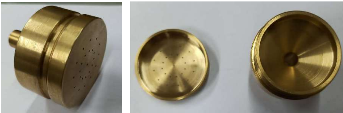
(ज) इम्पैक्ट पेनिट्रेशन सेट-अप के स्प्रे हेड (प्रमुख फुहारा) का निर्माण
