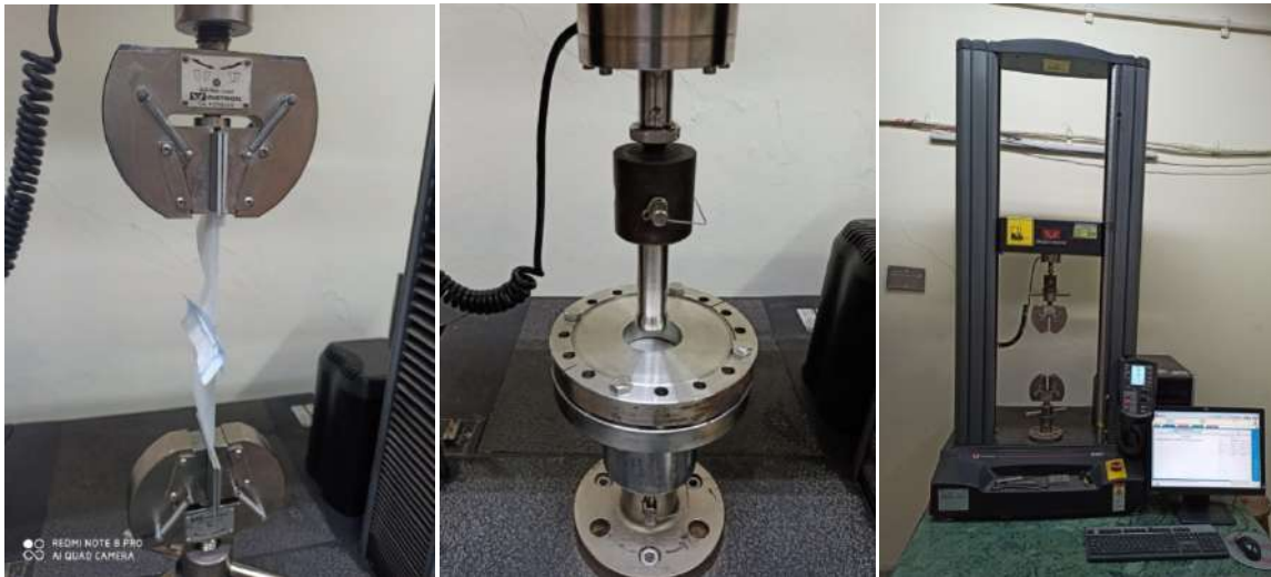
(अ) सीम/वेंसिल/टियर टेस्ट के लिए सेट-अप (ब) बॉल बर्स्ट टेस्ट के लिए सेट-अप (स) पीपीई नमूनों के लिए यूनिवर्सल टेस्टिंग मशीन (यूटीएम) (इंस्ट्रोन, 5967)
