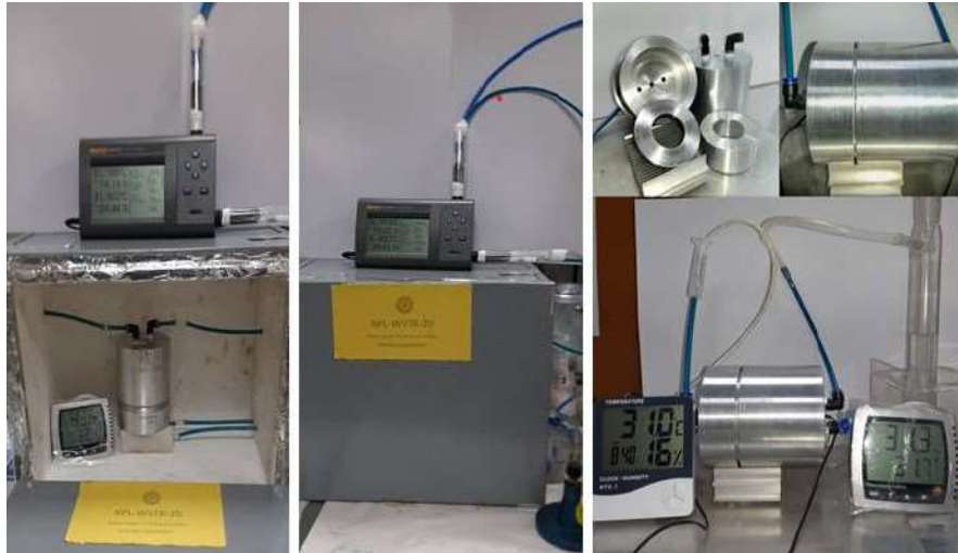
(द) पीपीई नमूनों के लिए जल तरंग संचरण दर (डब्ल्यूवीटीआर) परीक्षण के लिए सेटअप
